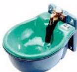
Heizbar für Wand- und Rohrbefestigung, mit Rohrventil. Schale aus Gusseisen, innen emailliert, alle Teile aus Edelstahl bzw. Messing. Anschluss 1/2", Wassermenge stufenlos von außen regulierbar, ohne Demontage des Ventils.
