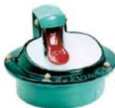
Heizbares Tränkebecken für Offenstallungen (Mod. 41A). Geeignet für Rinder, Pferde und Schweine. Schale aus Gusseisen, innen emailliert und mit robustem Zungenventil. Frostsicher bis ca. -25°C. Anschluss R 1/2 von unten.
